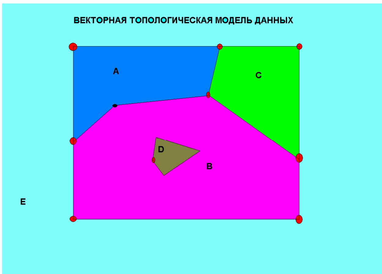
Рисунок 5 – Векторная топологическая модель данных
